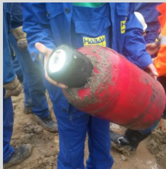
MTA Pipe-Inspector „Gas“ in Molch
