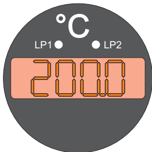
Frontplatte des Temperaturtransmitters MT 201 - mit 2 Open Collector Ausgängen - Limitpaare (2 LED Dioden schalten ein bei Einschaltung des externen Relais).
